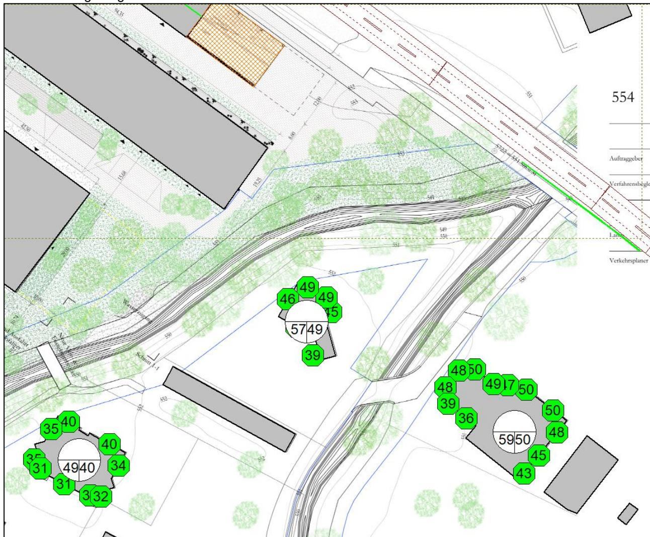
Durch die Kürzung der Lärmschutzwand entstehen für die relevanten Gebäude Zunahmen der Lärmbelastungen um maximal 5 dB am Tag und maximal 4 dB in der Nacht.
