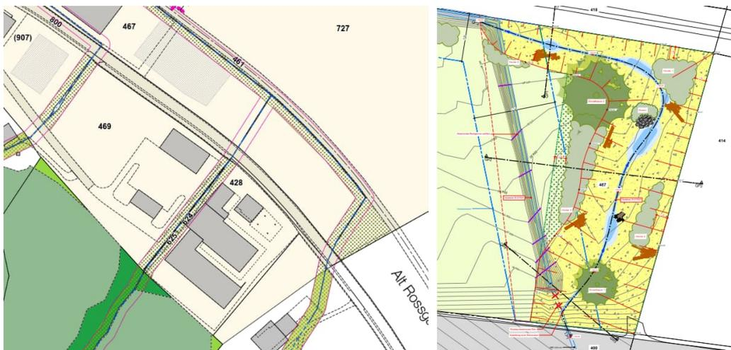
Abb. 11: Gewässerraum Seitenbäche Alt Rossgass, Aufhebung beim mittleren Bach und Kompensation im SE; rechts Aufwertungsprojekt
