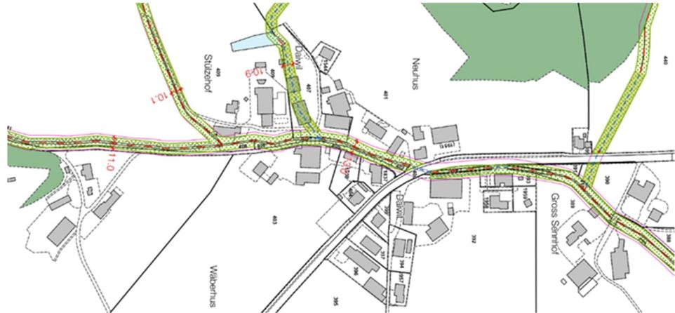
Abb. 25: Anpassung Gewässerraumbreite Riedtalbach, Daiwil; (Plan 90° gedreht, Fliessrichtung rechts)
